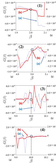
図 3:  $J_S$  の誤差のみを反映した  $G(\beta)$  のグラフ. 左の (a) は,  $J_S, \psi_{\max}, \psi_{\min}, P_S(\psi_{\max}), P_S(\psi_{\min})$  の測定誤差を 0 に近く設定し得られた (理想的)  $G(\beta)$ . 右の (b) は,  $J_S$  の測定誤差のみを反映した  $G(\beta)$ . (b) の場合, (a) で得られた  $G(\beta)$  と異なり, いずれも  $G(\beta) = 0$  となる推定値  $\beta$  は真値から, いくらか離れている. (1)  $\beta = 2.0$ , (2)  $\beta = 5.0$ , (3), (4)  $\beta = 10.0$ . (1, 2, 3) は  $f = 0.28$ , (4) のみ  $f = 0.26 \times 10^{-1}$  とした.
