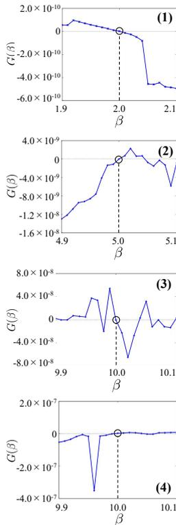
図 2: 測定誤差なしの  $G(\beta)$  のグラフ.  $J_S, \psi_{\max}, \psi_{\min}, P_S(\psi_{\max}), P_S(\psi_{\min})$  の測定誤差を (理想的観測により) 0 に近く設定した. (1)  $\beta = 2.0$ , (2)  $\beta = 5.0$ , (3), (4)  $\beta = 10.0$ . (1, 2, 3) は  $f = 0.28$ , (4) のみ  $f = 0.26 \times 10^{-1}$  とした. いずれも,  $G(\beta) = 0$  となる推定値  $\beta$  は (設定した  $\beta$  の) 真値に一致している.
