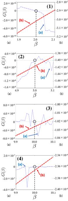
図4:  $\psi_{\min}$  の誤差のみを反映した  $G(\beta)$  のグラフ。左の (a) は,  $J_S$ ,  $\psi_{\max}$ ,  $\psi_{\min}$ ,  $P_S(\psi_{\max})$ ,  $P_S(\psi_{\min})$  の測定誤差を0に近く設定し得られた (理想的)  $G(\beta)$ . 右の (b) は,  $\psi_{\min}$  の測定誤差のみを反映した  $G(\beta)$ . (b) の場合, いずれも  $G(\beta) = 0$  となる推定値  $\beta$  は真値から, 大幅に離れている. (1)  $\beta = 2.0$ , (2)  $\beta = 5.0$ , (3), (4)  $\beta = 10.0$ . (1, 2, 3) は  $f = 0.28$ , (4) のみ  $f = 0.26 \times 10^{-1}$  とした.
